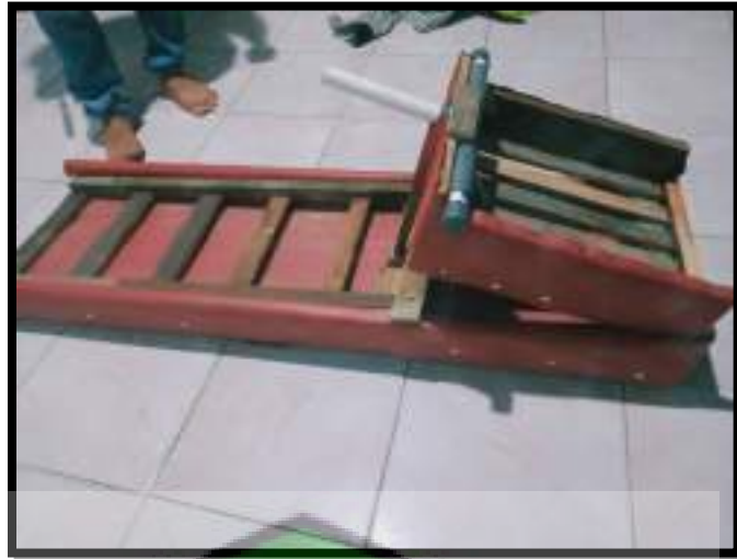
Gambar 4.14 Bentuk Jadi Sluice Box
